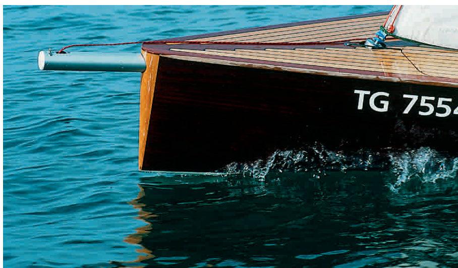
Aus dem Steven ragt der Gennakerbaum. Er kann bis zu zwei Meter ausgefahren werden
