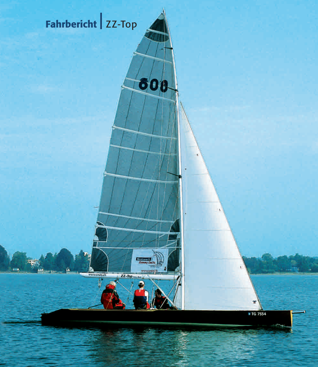
Der obere Teil des Mastes ist aus Kohlefaser. Dadurch lässt sich das Rigg optimal trimmen
